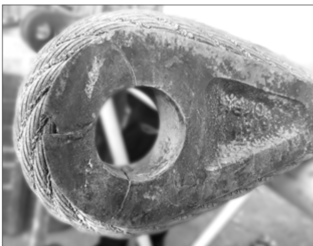
Abb.: Risse in einer Vollkausche
