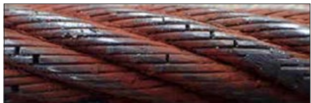
Abb.: Innere Korrosion - 100 % Ablegereife
