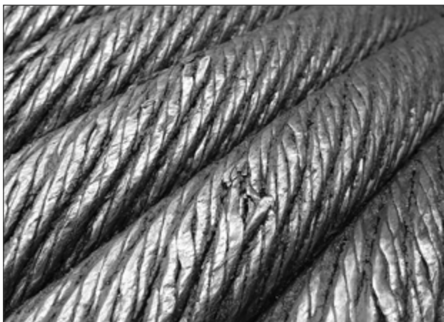
Abb.: Verschleiß in der Mehrlagenwicklung
