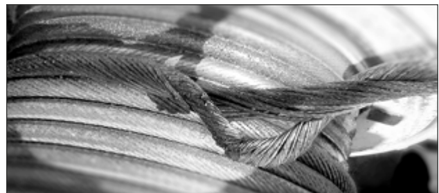
Abb.: Austritt der Stahleinlage beim nicht drehungsfreien (oben) und beim drehungsarmen (unten) Seil
