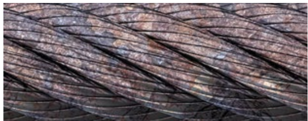
Abb.: Mittelschwere Korrosion – 40 % - 60 % Schweregrad
