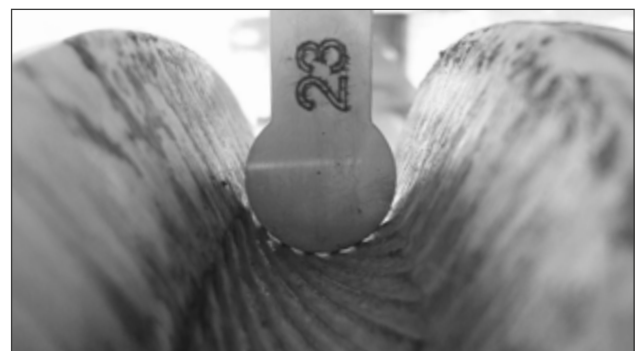
Abb.: Deutliche Abdrücke eines Seilnegativprofils
