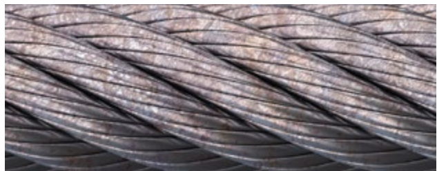
Abb.: Leichte Korrosion – 0 % - 20 % Schweregrad
