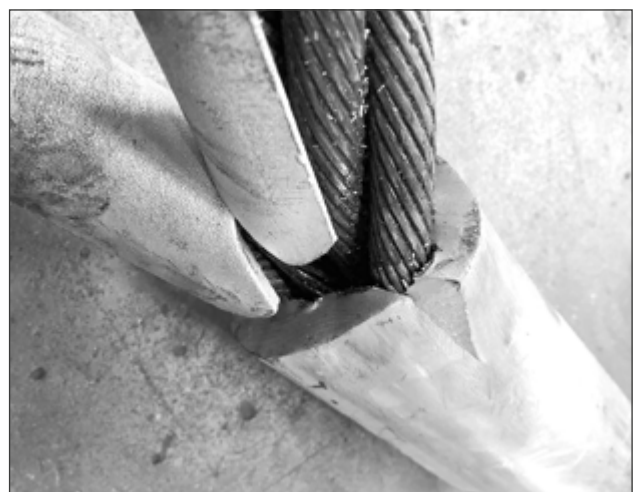
Abb.: Riss im Verpressbereich einer Aluminium-Pressklemme
