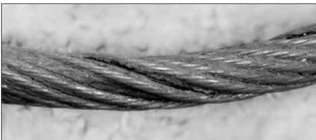
Abb.: Lokale Verringerung des Seildurchmessers
