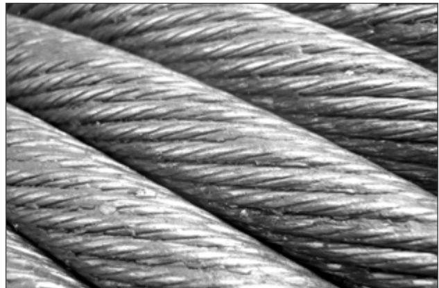
Abb.: Oberflächliche Korrosion "Flugrost"
