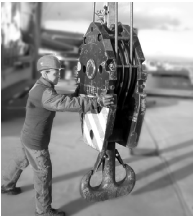
Abb.: Hakenflasche in neutrale Position drehen
