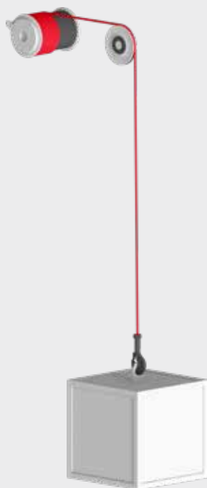
Heben einer ungeführten Last im Einstrangbetrieb
